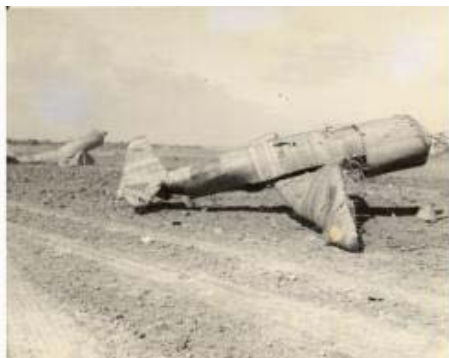
資料名 沖縄戦米軍記録写真0165 規格 20×25cm 解説 嘉手納飛行場の周辺。米軍機の機銃掃射をおびきよせるための、数多い竹製のオトリ機が配置された。
