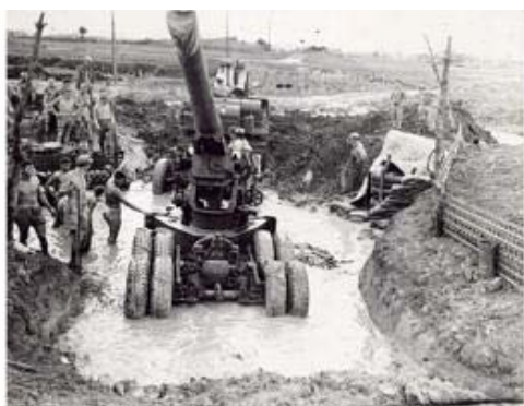
資料名 沖縄戦米軍記録写真0105 規格 20×25cm 解説 5月27日、水たまりにはまった155ミリ砲を引き揚げる米海兵隊のブルドーザー。
